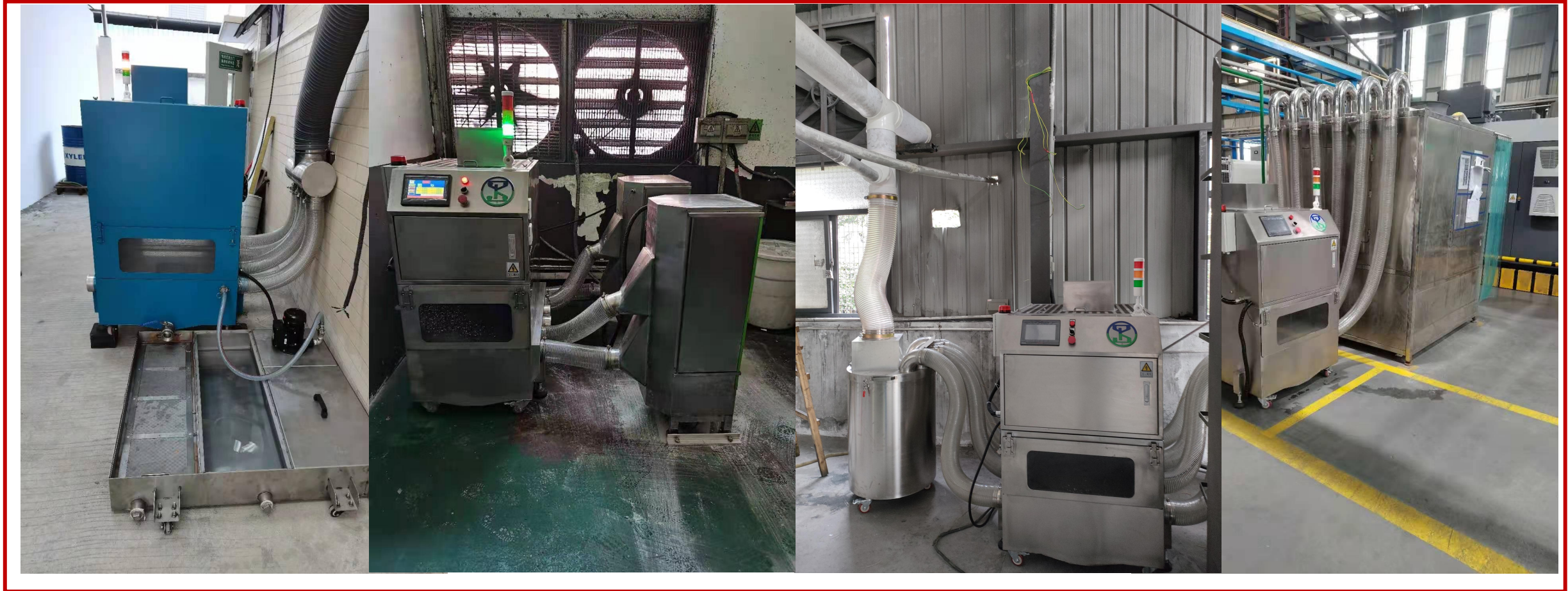
自激湿式除尘器 喷砂、抛丸、抛光作业 应用案例
