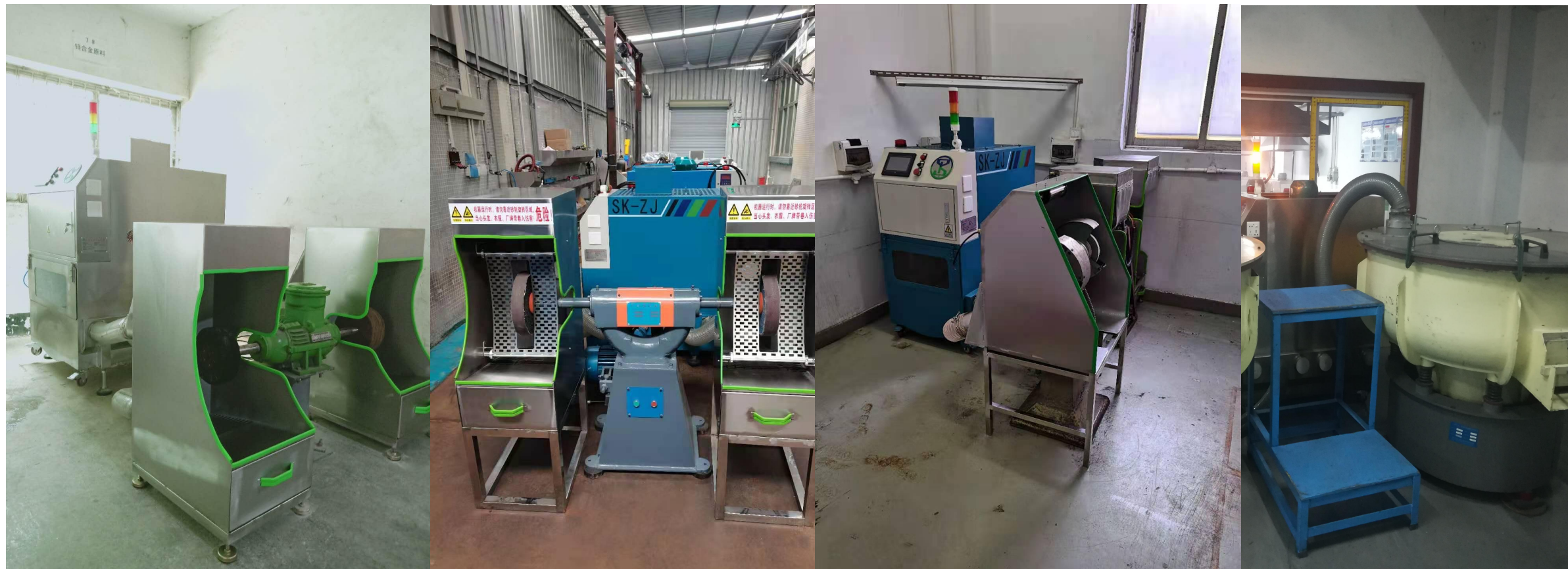
自激湿式除尘器 抛光、拉丝、干式研磨作业 应用案例
